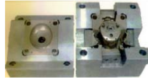
焼結成形された射出成型用金型
